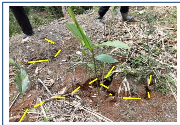
Gambar 5. Infiltrasi air melalui zona rekahan akan meningkatkan faktor pembebanan tanah.
