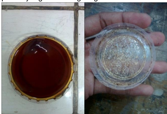
Gambar 5. Bioplastik dari kulit garut sebelum dan sesudah terdegradasi EM-4
