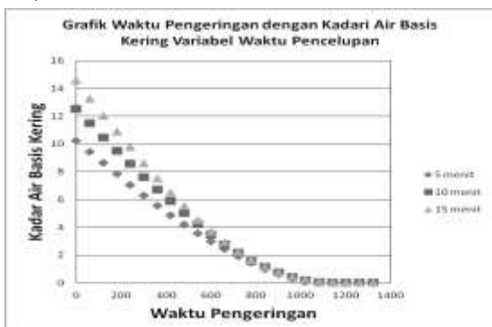
Gambar 7. Grafik Hubungan antara Kadar Air Basis Kering dengan Kecepatan Pengeringan pada Variabel Waktu Pencelupan
