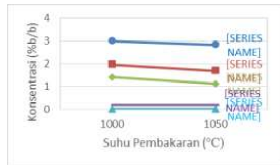
Gambar 5. Grafik Pengaruh Suhu Pembakaran terhadap Perubahan Komposisi Kimia Produk Semen (Perbandingan Berat Bahan, Batu Kapur : Clay : Abu Vulkanik : Pasir Besi ; 34,94 : 16,80 : 28,99 : 19,26)
