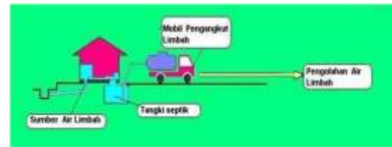
Gambar 3. Sistem pengolahan limbah cair setempat
